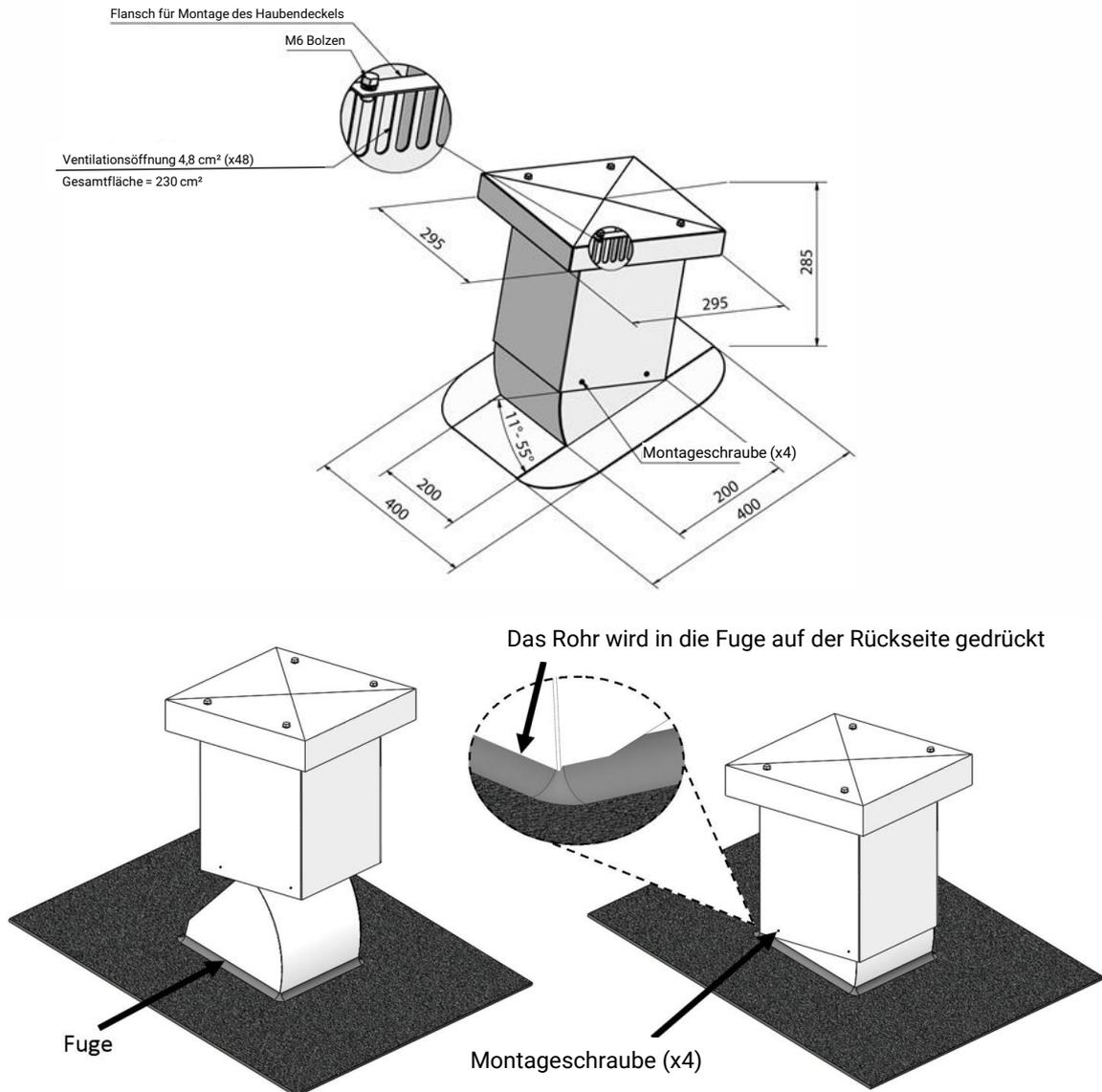
Für einen zusätzlichen Schutz vor dem Eindringen von Wasser wird empfohlen, eine durchgehende Fuge zwischen dem unteren Teil der Entlüftungshaube und der Dachfläche anzubringen. Bei der Montage der Entlüftungshaube wird diese in die Fuge auf der Rückseite (untere Seite) des Unterteils gedrückt und anschließend beidseitig mit den mitgelieferten Montageschrauben (x4) gesichert.
