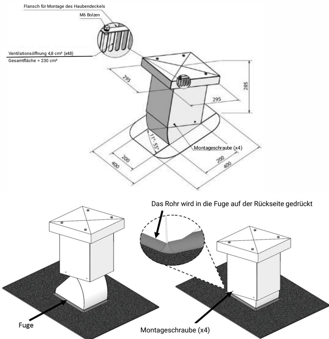
Für einen zusätzlichen Schutz vor dem Eindringen von Wasser wird empfohlen, eine durchgehende Fuge zwischen dem unteren Teil der Entlüftungshaube und der Dachfläche anzubringen. Bei der Montage der Entlüftungshaube wird diese in die Fuge auf der Rückseite (untere Seite) des Unterteils gedrückt und anschließend beidseitig mit den mitgelieferten Montageschrauben (x4) gesichert.
